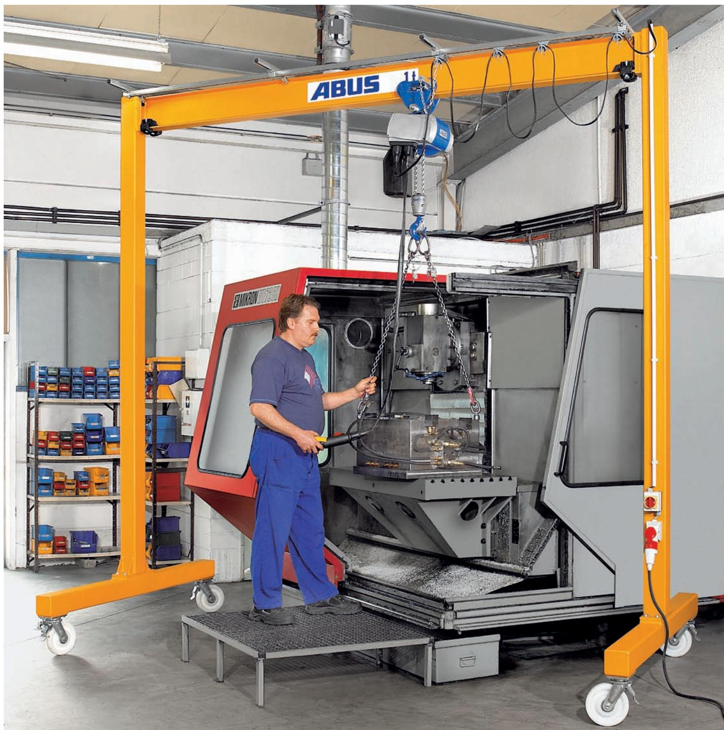
Med ABUS lettportalkran blir ABUS kjettingtaljer mobile. Med kapasitet opptil to tonn og med fire sving- og låsbare hjul stiller den til enhver tid sin løftekapasitet til disposisjon der hvor du har beov for den. Ved behov kan ABUS lettportalkranen demonteres, og med to byggestørrelser er det mulig å tilpasse seg kravene til høyde og bredde innenfor et vidt område.
